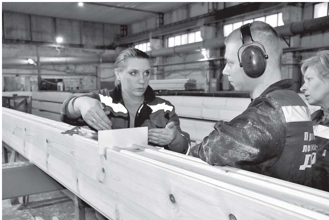
Ольга Хакимова (слева) с контролером ОТК Татьяной Абрамовой и станочником Антоном Коником проводят измерение бруса и проверку соответствия профиля шаблонам.
